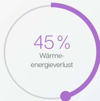
Bei alten Fenstern entweichen in der Regel nahezu 45% der Wärmeenergie an die Umgebung – obwohl die Fenster im Schnitt nur 10% der Gebäudehülle ausmachen.
